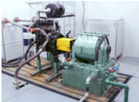
电涡流测功机试验台架系统 Eddy Current Dynamometer Test Bench System
