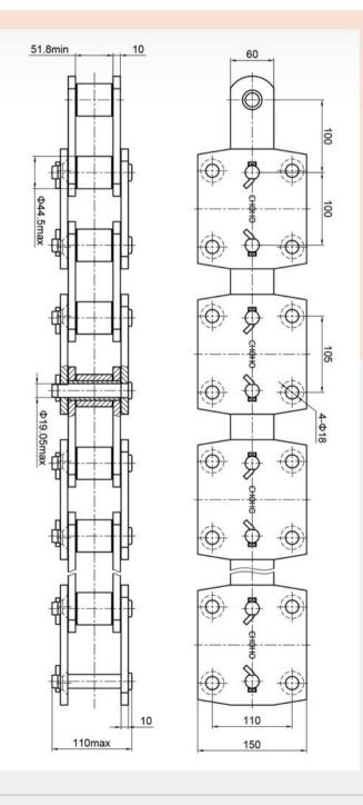
水泥链应用于大粉尘恶劣环境、工作环境复杂,征和采用"两磨一烧"独特的工序以及焊接和精冲技术相结合,并采用独特的设计和工艺技术、具有自主专利技术的密封结构,避免粉尘进入,使得链条运行精度高、使用寿命长。
