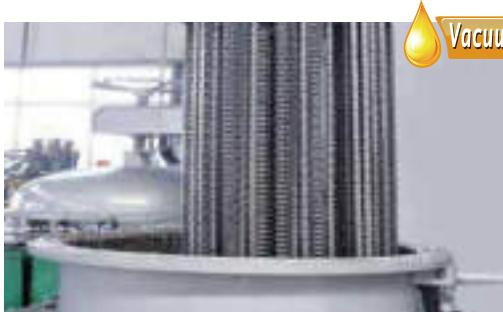
真空上油技术：利用真空泵对上油容器抽出空气，使链条零件内部空气被抽出，形成负压，使各零件缝隙中充满耐磨油脂。该项技术使链条上油均匀充分，润滑良好，很好的提高了链条的耐磨性能和使用寿命。
