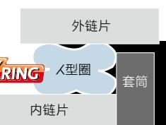
▲X型圈封住润滑油出口的方式
