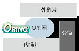
▲O型圈封住润滑油出口的方式
