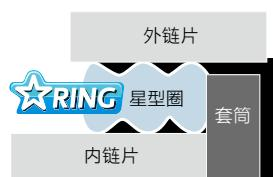
▲星型圈封住润滑油出口的方式
